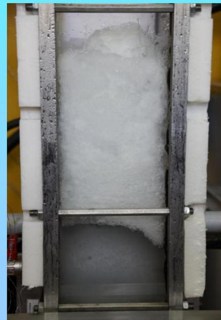
Образец полученного газового гидрата CO<sub>2</sub>
