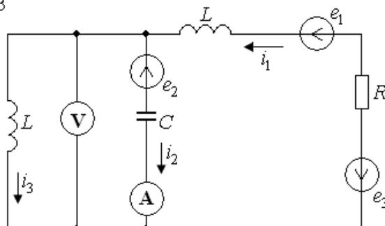
Figure 4  $R=X_L=20 \text{ Ом}, X_C=10 \text{ Ом}$
