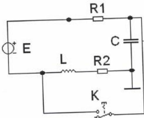
39. Получить графики  $u_C(t)$  и  $i_B(t)$  для переходного процесса в данной схеме при переключении источника постоянного тока с  $E_2=15$  В на  $E_1=5$  В, если  $R_1=1$  кОм,  $R_2=2$  кОм,  $C=1$  мкФ,  $L=0.1$  Гн, используя структурную модель в Simulink.
