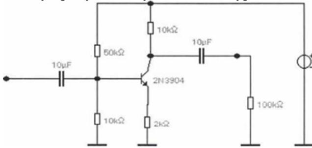
31. Подготовить макромодель усилителя и получить осциллограммы входного и выходного напряжений при импульсном возбуждении прямоугольными импульсами частотой 1 кГц., используя DC7.
