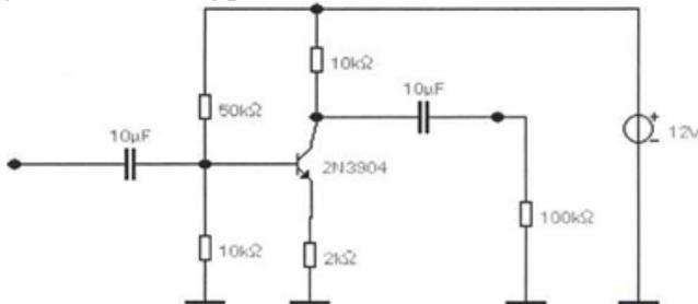
10. Получить графики входного и выходного напряжений и определить коэффициент усиления усилителя на биполярном транзисторе 2N3904 при синусоидальном входном сигнале ( $U_m=100$  мВ,  $f=1$  кГц), используя MicroCAP.
