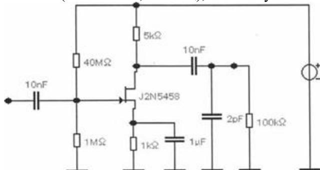
42. Получить график амплитудно-частотной характеристики избирательного усилителя и определить полосу пропускания по уровню  $0.707K_{max}$ , используя DC7.
