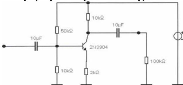
6. Определить наибольший коэффициент усиления по току биполярного транзистора 2N3904 ( $h_{21}=dI_c/dI_b$ ), используя MicroCAP 5.
