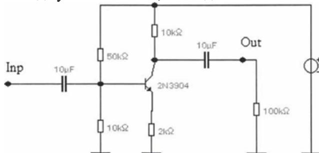
23.Подготовить макромодель усилителя и получить осциллограммы входного и выходного напряжений при импульсном возбуждении прямоугольными импульсами частотой 1 кГц., используя Electronics Workbench.
