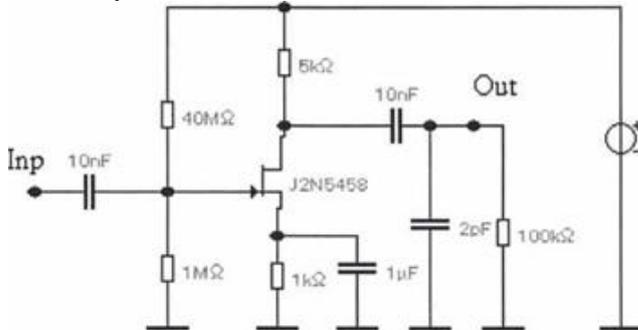
27. Получить графики входного и выходного напряжений и определить коэффициент усиления по напряжению для избирательного усилителя на частоте 48.8 кГц при амплитуде входного сигнала 10 мВ, используя Electronics Workbench 3.
