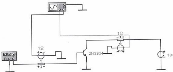
33. Получить семейство амплитудно- частотных характеристик усилителя на биполярном транзисторе при ступенчатом изменении емкости разделительного конденсатора на выходе усилителя от 0,1мкФ до 100 мкФ с шагом 10 мкФ, используя DC7. Задать разброс Rk 10%. Получить гистограммы для maxKi при равномерном законе распределения.
