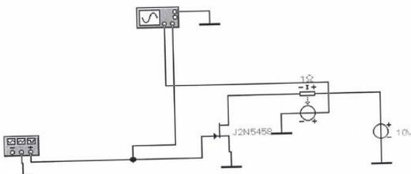
12. Получить графики амплитудно- и фазочастотной характеристик усилителя на полевом транзисторе 2N5455, используя MicroCAP 5. Определить полосу пропускания усилителя по уровню 0.707Kмаx
