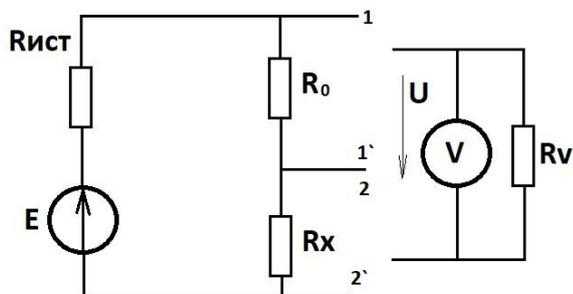
В процессе измерения вольтметр V сначала подключают к зажимам 1-1' (получают результат измерения  $U_0$ ), затем подключают его к зажимам 2-2'
