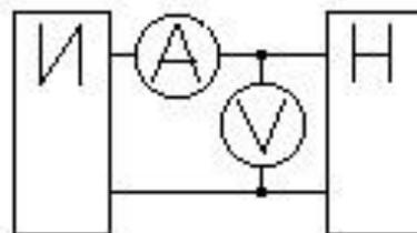
11.Мощность P, потребляемая нагрузкой (Н) от источника постоянного тока (И), измеряется косвенно с помощью постоянно подключенных вольтметра (V) и амперметра (A). Расчет выполняется по формуле  $P = I \cdot U$ , где I, U - показания, соответственно, А и V. При этом не учитывается влияние на результат измерения внутреннего сопротивления приборов, что приводит к погрешности метода.
