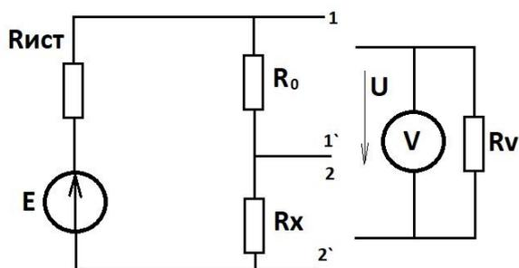
В процессе измерения вольтметр  $V$  сначала подключают к зажимам 1-1' (получают результат измерения  $U_0$ ), затем подключают его к зажимам 2-2' - получают  $U$ .
