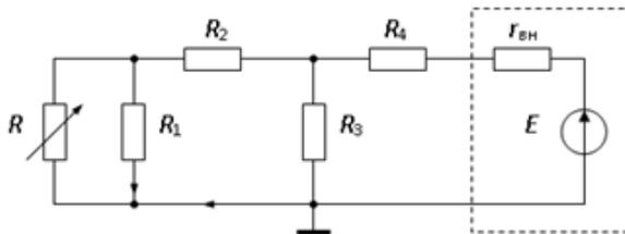
Figure 2 Найти параметры эквивалентного генератора относительно  $R_2$
