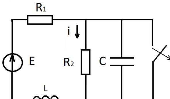
Figure 9  $R_1 = R_2 = 10$  Ом,  $C = 10 \cdot 10^{-3}$  Ф,  $L = 1$  Гн,  $E = 100$  В Найдите ток  $i$  методом составления уравнений состояния
