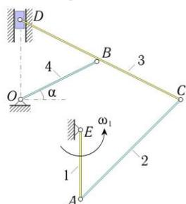
В стержневом механизме кривошип  $AE$ , длины  $l$ , вращается с известной угловой скоростью  $\omega_1$ . Известно, что  $BO = BC = BD = l$ . В положении, указанном на рисунке, определить угловые скорости всех звеньев и скорость точки  $D$ .
