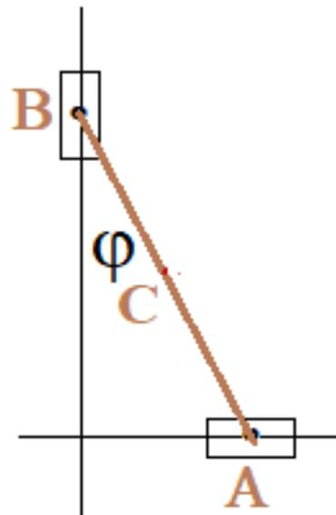
2. Определите обобщённую силу, обусловленную действием силы  $F$ , перпендикулярной стержню и приложенной в его середине. Обобщённая координата угловая, длина стержня  $L$
