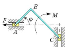
Составить дифференциальное уравнение движения системы, состоящей из невесомого уголка и двух ползунов, массы которых равны  $m_1$ ,  $m_2$ . На уголок действует пара сил с моментом  $M$ . К ползуну  $A$  приложена сила  $F$ . Дано:  $BC = 2AB = 2l$ . За обобщенную координату принять угол  $\varphi$ .
