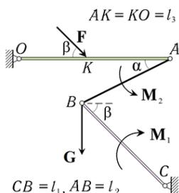
Три невесомых стержня соединены между собой и основанием шарнирами. На стержень  $AO$  действует сила  $F$ . На стержни  $AB$  и  $BC$  действуют пары сил с моментами  $M_1$  и  $M_2$ . Чему должна быть равна сила  $G$ , чтобы система находилась в равновесии?
