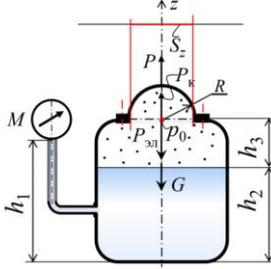
Условие равновесия сил, действующих на выделенный объект (крышку с фланцем) в проекции на ось  $z$ :
