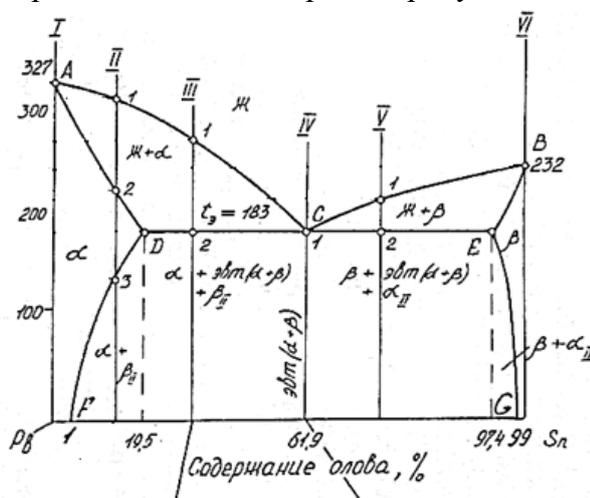
2. Опишите процесс кристаллизации сплава V
