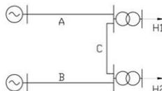
Система передачи электроэнергии состоит из источников энергии, трансформаторов и линий электропередачи А,В,С. Источники электроэнергии и шины считаем абсолютно надежными элементами. Показатели надежности линий и трансформаторов следующие :
