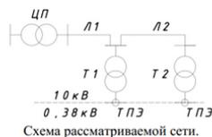
Точки передачи электроэнергии – шины 0,4 кВ, допустимые границы отклонения напряжения в точках передачи:  $\pm 7 - \pm 2 \% U_{ном}$ .
