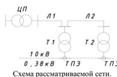
Точки передачи электроэнергии – шины 0,4 кВ, допустимые границы отклонения напряжения в точках передачи:  $\pm 7,5 - \pm 1,5 \% U_{ном}$ .
