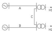
Система передачи электроэнергии состоит из источников энергии, трансформаторов и линий электропередачи А,В,С. Источники электроэнергии и шины считаем абсолютно надежными элементами. Показатели надежности линий и трансформаторов следующие :
