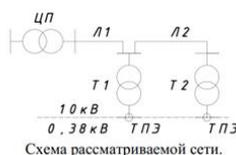
Точки передачи электроэнергии – шины 0,4 кВ, допустимые границы отклонения напряжения в точках передачи:  $\pm 6 - -3$  %  $U_{ном}$ .
