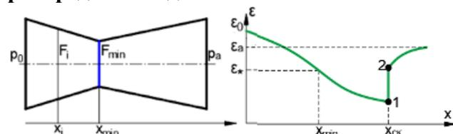
15. Где в канале с переменной площадью сечения может быть достигнута скорость звука?
