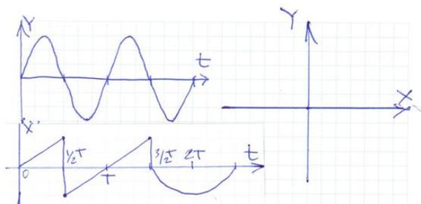
32. На входе вертикального отклонения Y ЭЛО действует синусоидальное напряжение. На входе горизонтального отклонения ЭЛО действует напряжение, представленное в задании. Генератор развертки ЭЛО выключен. Найти изображение на экране ЭЛО.
