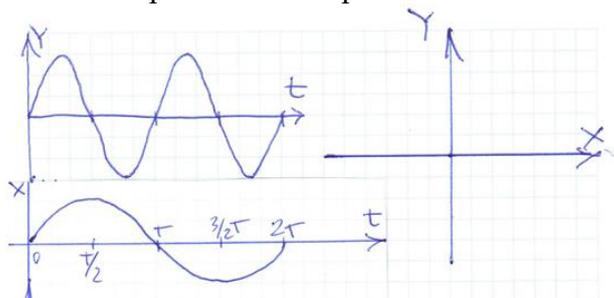
8. На входе вертикального отклонения Y ЭЛО действует синусоидальное напряжение.
