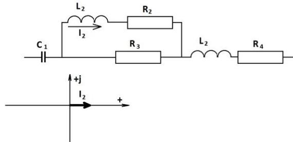
6. Найти  $Z_{\Sigma}$ ,  $Q_{\Sigma}$  и построить диаграмму токов и напряжений, начиная с тока  $I_2$ .
