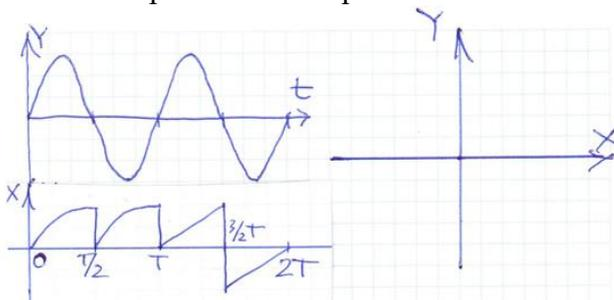
9. На входе вертикального отклонения Y ЭЛО действует синусоидальное напряжение.
