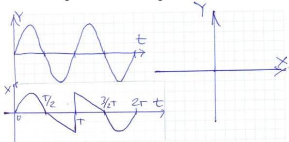
5. На входе вертикального отклонения Y ЭЛО действует синусоидальное напряжение.
