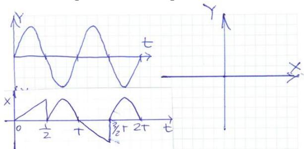
7. На входе вертикального отклонения Y ЭЛО действует синусоидальное напряжение.
