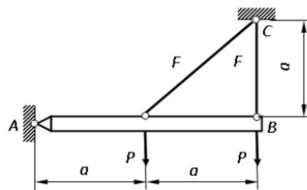
Как изменятся напряжения в стержнях при установившейся ползучести? Параметры, указанные на рисунке, а также  $A$ ,  $n$  считать известными.
