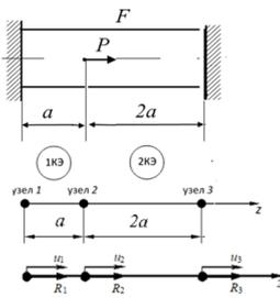
При определении перемещений методом конечных элементов в заданном стержне вектор эквивалентных узловых нагрузок имеет вид:
