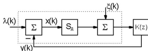
Рисунок. Обобщённая структурная схема следящей системы  $K(z) = \frac{1-d}{z-d}$ .
