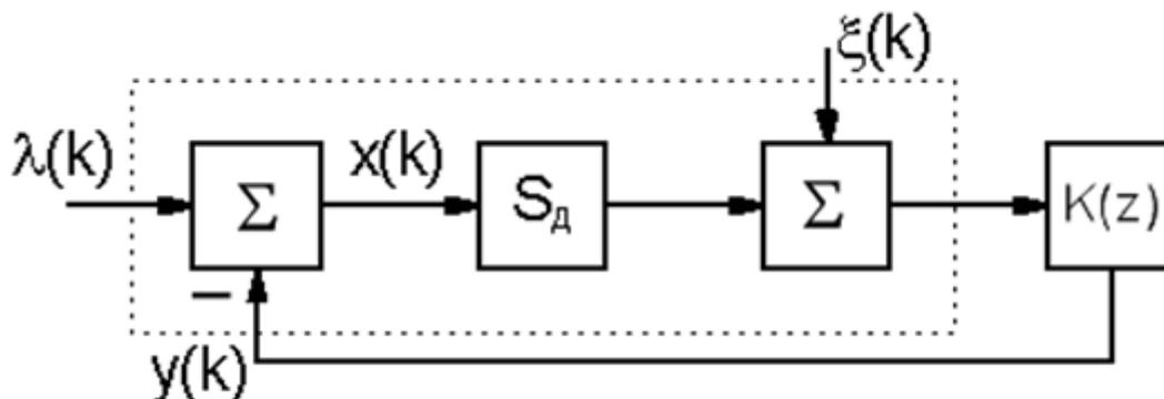
Рисунок . Обобщённая структурная схема дискретной СРА.
