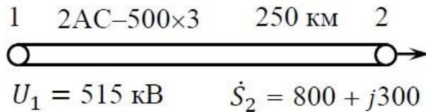
2. Построить векторные диаграммы токов и напряжений электрической сети без учета потерь мощности для сети, схема замещения которой приведена на рис
