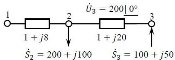
3. Определить потокораспределение в сети, приведенной на рис. без учета потерь мощности и генерации линий, и напряжения узлов. Построить векторные диаграммы напряжений и токов. Нагрузки заданы в мегавольтамперах, сопротивления — в омах
