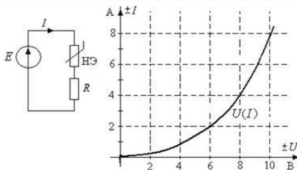
2. Вольтамперная характеристика нелинейного элемента задана таблично и графически. Определить напряжение на нелинейном элементе U12.
