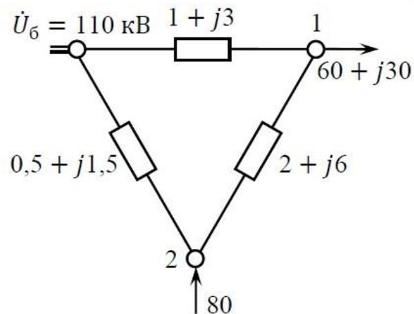
4. Определить токи в ветвях сети линии с двухсторонним питанием с разными напряжениями по концам передачи:  $U_A$  115 кВ,  $U_B$  110 кВ. Схема замещения сети приведена на рис., токи указаны в килоамперах, сопротивления — в омах
