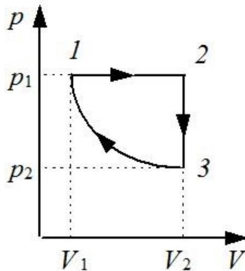
5. На рисунке приведена диаграмма (P, V) изменения параметров состояния некоторой массы газа. Укажите в данном термодинамическом процессе количество теплоты, подводимое к газу
