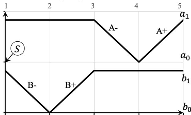
2. Разработать электропневматическую схему управления по заданной циклограмме на базе бистабильных распределителей
