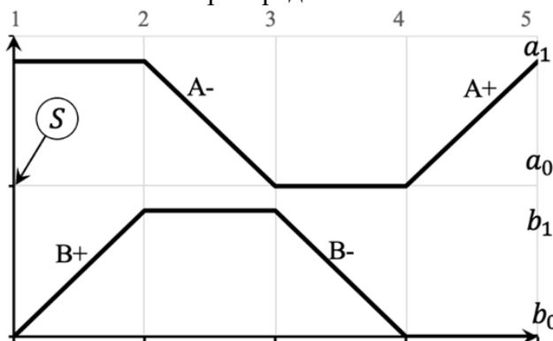
3. Разработать электропневматическую схему управления по заданной циклограмме на базе моностабильных распределителей
