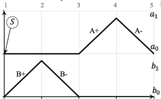
3.Продемонстрируйте циклограмму, соответствующую представленной пневматической схеме
