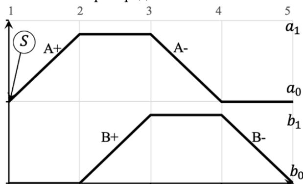
2. Разработать электропневматическую схему управления по заданной циклограмме на базе моностабильных распределителей
