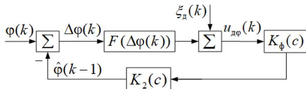
Figure 1 Рисунок 1. Структурная схема нелинейной дискретной ССЧ
