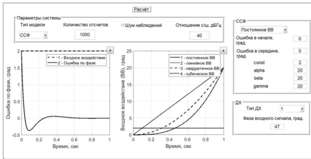
Рисунок 2. Интерфейс модели системы слежения за фазой сигнала
