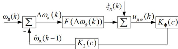
Рисунок 2. Структурная схема нелинейной дискретной ССЧ
