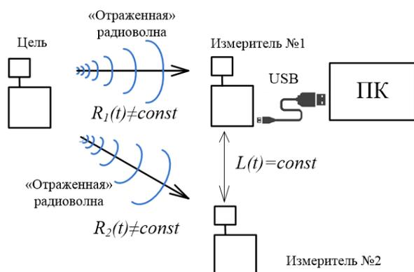
Рисунок 1. К описанию лабораторной установки: ПК - персональный компьютер
