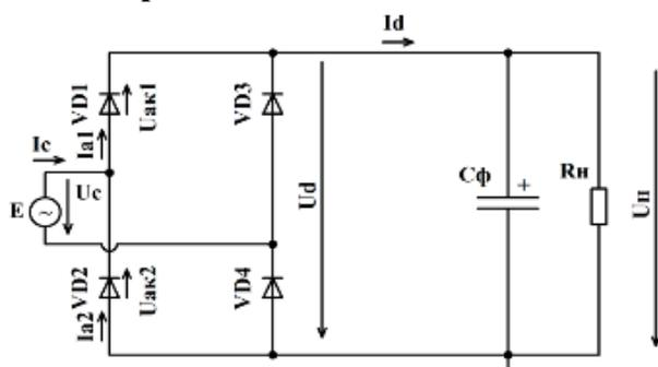
Figure 1 Принципиальная схема выпрямителя
