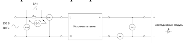
Figure 1 Рис. 1 Схема экспериментальной установки для исследования гармонического состава тока потребления ИП и СМ.
