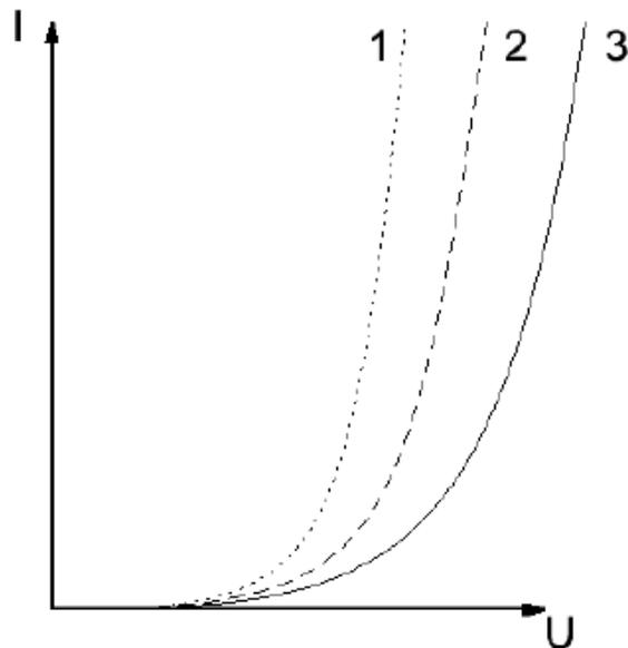
Уметь: объяснять на основе физических процессов вольт-амперные характеристики полупроводниковых приборов
