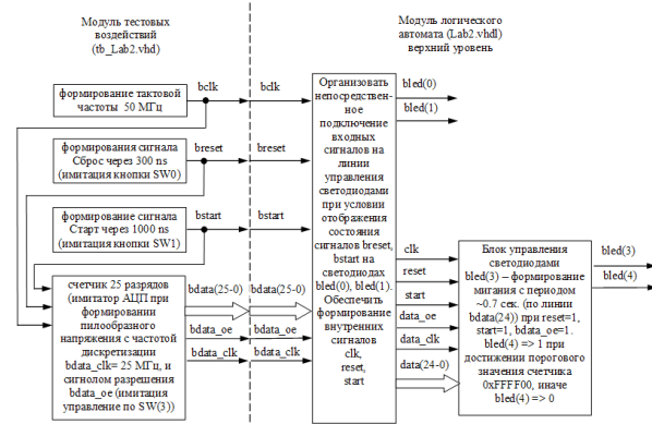
Схема логического автомата и теста для лабораторной работы 2.
