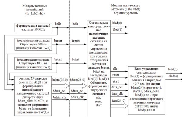
Комментарий к схеме 2: блок управления светодиодами строится на основе счетчика и шифратора. Эти модули следует реализовать в отдельных файлах. На верхнем уровне проекта следует:
