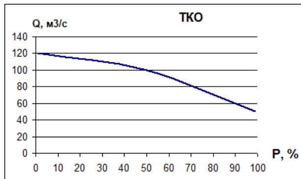
Рассчитайте значение технико-экологического потенциала участка водотока при условии его использования каскадом русловых ГЭС с заданными техническими параметрами ( $K_n=8,2$  и рабочий диапазон напоров от 3 до 10 м), предварительно проверив возможность ее установки на данном водотоке. Представьте графически размещение каскада МГЭС на данном участке водотока и оцените их параметры: мощность, напор и расход.
