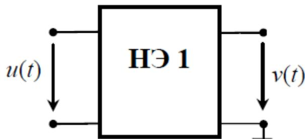
4. К выходу нелинейного элемента подключен колебательный контур (рис. 1) с резонансной частотой 2 кГц. На вход нелинейного элемента подается гармонический сигнал:  $u(t) = 0,2 + 0,6\cos(2\pi 10t)$  (В). Нелинейный элемент имеет характеристику, которая аппроксимируется кусочно-линейной функцией с напряжением начала характеристики 0,2 В и крутизной 0,5. Коэффициент передачи контура на резонансной частоте 0,8. Рассчитайте амплитуду напряжения на контуре.
