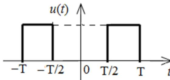
9. Найдите и постройте взаимную корреляционную функцию  $\Psi_{uv}(\tau)$  прямоугольных видеоимпульсов  $u(t)$  и  $v(t)$  с амплитудами  $U_1$  и  $U_2$  и длительностью  $T$  и  $T/2$  соответственно.
