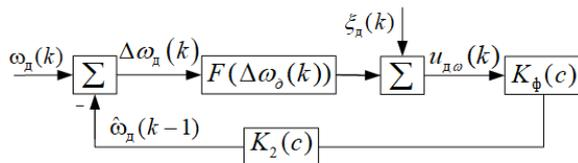
Рисунок 2. Структурная схема нелинейной дискретной ССЧ
