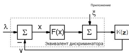
Рисунок 1. Структурная схема обобщённой дискретной системы радиоавтоматики
