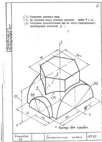
по реальной модели построить 6 видов и дополнительный вид на проецирующую плоскость
