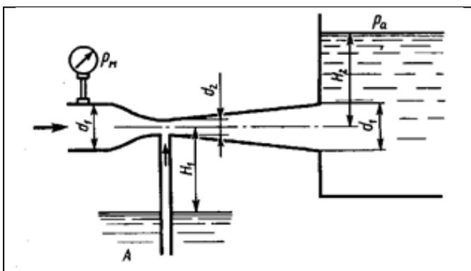
Определить минимальное давление  $p_m$ , измеряемое манометром перед сужением трубы, при котором будет происходить подсосывание воды из резервуара  $A$  в узком сечении трубы. Размеры:  $d_1=60$  мм;  $d_2=20$  мм;  $H_1=6$  м;  $H_2=1$  м. Принять коэффициенты сопротивления: со-пла  $V_c=0,08$ , диффузора  $V_{диф}=0,30$ .
