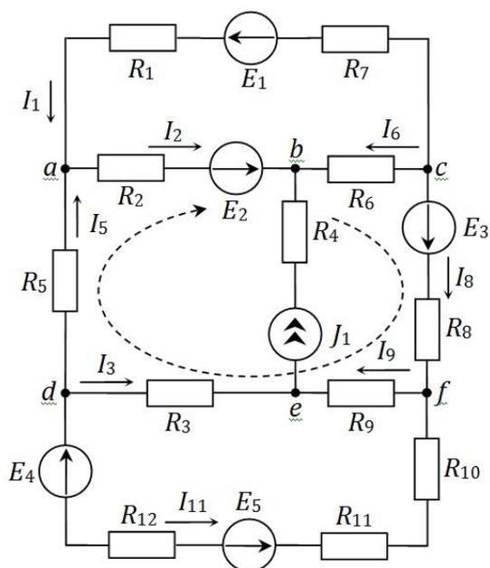
$$I_5 R_5 + I_2 R_2 + I_6 R_6 + I_8 R_8 + I_9 R_9 + I_3 R_3 = 0$$
