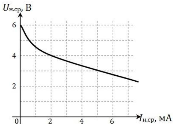
**Вопрос 11.** Напряжение на нагрузке в идеальном выпрямителе представлено своей осциллограммой  $u_H(t)$ . Рассчитать значение выпрямленного тока нагрузки  $I_{H.c.p.}$ , если сопротивление нагрузки равно 2,5 кОм. (6 баллов)
