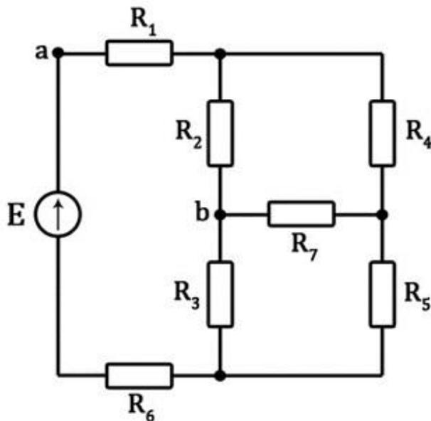
**Задача 18.** Используя метод эквивалентного активного двухполюсника, определить параметры его последовательной схемы замещения ( $E_{\text{эк}}$  и  $R_{\text{эк}}$ ) относительно зажимов  $a$  и  $b$  в схеме.  $E = (16V)$  В. Значения сопротивлений:  $R_1 = 3 \text{ Ом}$ ,  $R_2 = 2 \text{ Ом}$ ,  $R_3 = 0$ ,  $R_4 = 2 \text{ Ом}$ ,  $R_5 = 4 \text{ Ом}$ .
