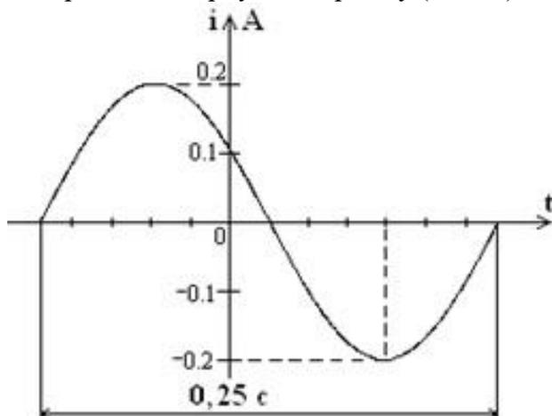
**Задача 2.** Определить параметры последовательной схемы замещения приемника, если  $f = 50$  Гц. Изобразить его схему замещения. Построить векторную диаграмму (1,5 балла)
