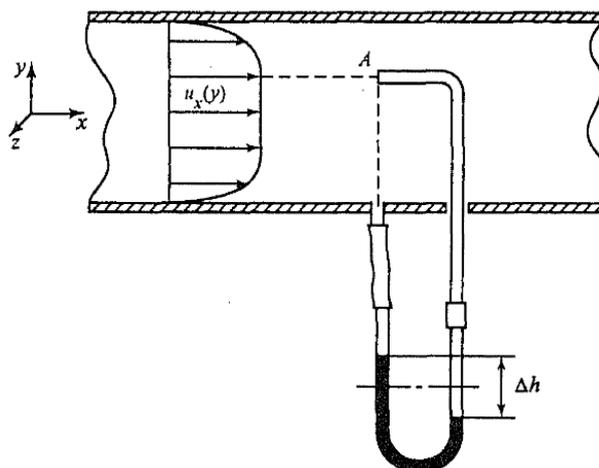
2. Определить скорость течения жидкости в трубе Вентури, используя перепад давления  $\Delta P = \rho_g g h$ , плотность жидкости и геометрические параметры устройства
