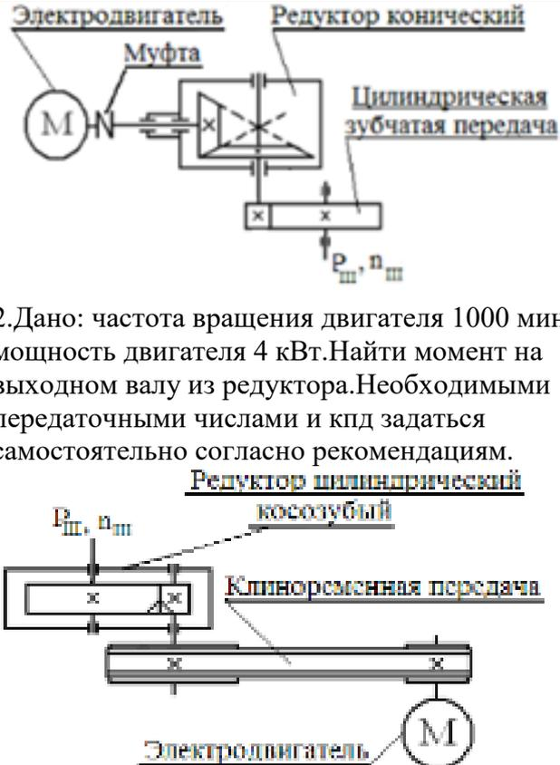
2. Дано: частота вращения двигателя 1000 мин<sup>-1</sup>, мощность двигателя 4 кВт. Найти момент на выходном валу из редуктора. Необходимыми передаточными числами и КПД задаться самостоятельно согласно рекомендациям.
