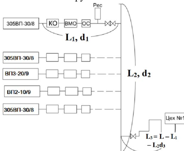
Для определения давлений на каждом участке схемы строится зависимость изменения давления по длине трубопровода в диагонали  $P_{н}$  компрессора и  $P_{вх}$  ввода потребителя, с помощью которой в первом приближении находят средние давления  $P_{сж}$  на каждом участке.
