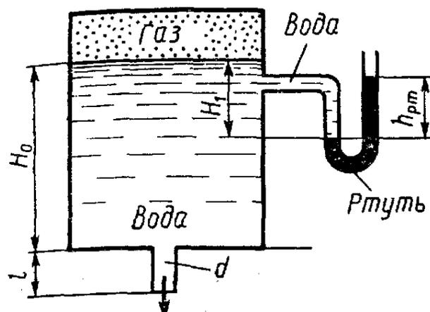
3. Определить расход воды, вытекающей из бака через короткую трубку (насадок) диаметром  $d=30$  мм и коэффициентом сопротивления  $V=0,5$ , если показание ртутного манометра  $h_{рт}=1,47$  м;  $H_1=1$  м;  $H_0=1,9$  м;  $l=0,1$  м.
