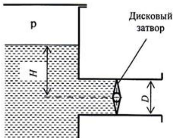
1. Закрытый резервуар с жидкостью плотностью  $900 \text{ кг/м}^3$  имеет выпускную трубу диаметром  $D = 0,5 \text{ м}$ , перекрытую дисковым затвором. Избыточное давление в резервуаре равно  $p = 8 \text{ кПа}$ , уровень жидкости находится над горизонтальной плоскостью, проходящей через ось затвора, на высоте  $H = 0,65 \text{ м}$ . Найти силу давления  $R$  на затвор и момент  $M$  этой силы относительно оси поворота затвора.
