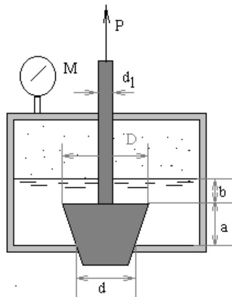
Отверстие в дне сосуда, содержащего масло относительной плотностью  $d = 0,83$ , закрыто конической пробкой с размерами  $D = 100$  мм,  $d = 50$  мм и  $a = 100$  мм, укрепленной на штоке диаметром  $d_1 = 25$  мм.
