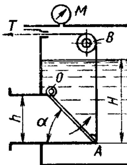
2. Поворотный клапан  $AO$  закрывает выход из бензохранилища в трубу квадратного сечения со стороной  $h = 0,3 \text{ м}$ . Прямоугольная пластина
