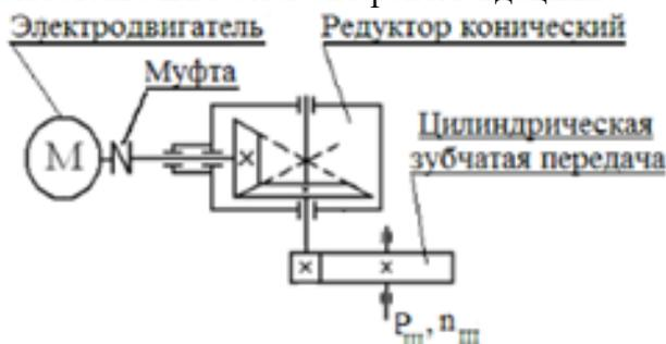
2. Дано: частота вращения двигателя 1000 мин<sup>-1</sup>, мощность двигателя 4 кВт. Найти момент на выходном валу из редуктора. Необходимыми передаточными числами и КПД задаться самостоятельно согласно рекомендациям.
