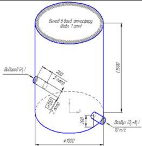
2. Определить скорость подвода топлива (метана) в канале заданной геометрии (для достижения  $\alpha=1,1$ ). Произвести расчёт смешения и горения компонентов в двух вариантах:
