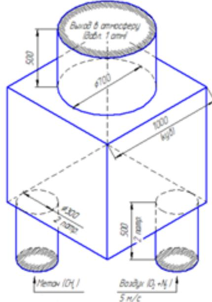
3. Определить скорость подвода топлива в канале заданной геометрии (пропана) (для достижения  $\alpha=1,07$ ). Произвести расчёт смешения и горения компонентов в двух вариантах:
