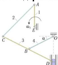
В стержневом механизме кривошип  $AE$ , длины  $r_1$ , вращается с известной угловой скоростью  $\omega_1$ . Известно, что  $BO = BC = BD = l$ . В положении, указанном на рисунке, определить угловые скорости всех звеньев и скорость точки  $D$ .
