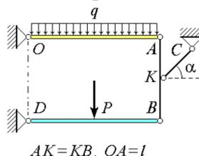
Четыре невесомых стержня соединены между собой и основанием посредством шарниров. На стержень  $AO$  действует равномерно распределенная нагрузка интенсивности  $q$ . Посредине стержня  $BD$  приложена вертикальная сила  $P$ . Найти реакции в точках  $O$  и  $D$ , а также усилие в стержне  $KC$ .
