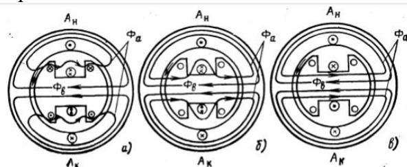
3. Какому сопротивлению соответствует картина распределения магнитного поля в режиме короткого замыкания синхронного генератора?
