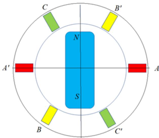
8. Электромеханическая система состоит из постоянного магнита, вращающегося в системе трехфазных катушек с постоянной скоростью. Изобразите графики изменения момента, действующего на неподвижный постоянный магнит, если в катушках задана трехфазная система переменных токов. Начальный угол показан на рисунке.
