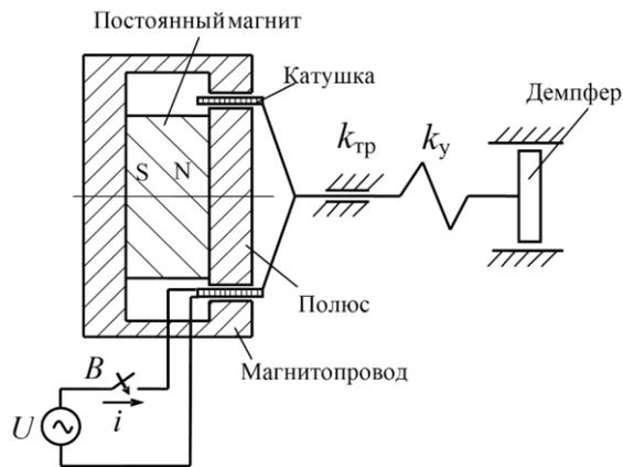
7. Электромеханическая система с магнитной муфтой. Составьте эквивалентную схему ЭМС в Matlab Simulink.
