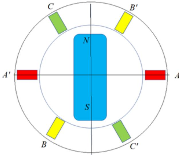
Figure 5 Схема генератора
