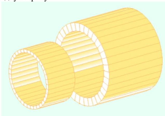
2. Электромеханическая система состоит из двух катушек. Маленькая катушка движется с постоянной скоростью вдоль оси катушек и полностью проходит через большую катушку. Изобразите график изменения потокосцепления большей катушки, от взаимного положения катушек, если ток только в меньшей катушке.
