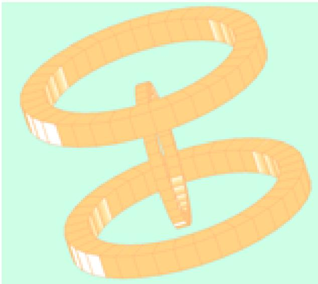
6. Электромеханическая система состоит из постоянного магнита, вращающегося в системе трехфазных катушек с постоянной скоростью. Изобразите график изменения момента, действующего на постоянный магнит при его вращении, если в катушках задано мгновенное значение трехфазной системы токов в момент максимума тока в фазе А.
