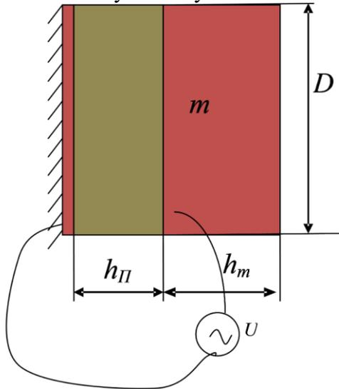
4. Электромеханическая система магнетогидродинамического генератора. Составьте эквивалентную схему ЭМС в Matlab Simulink.
