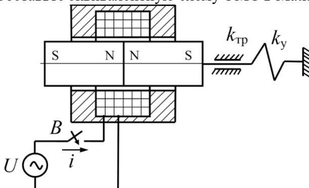
6. Электромеханическая система электромеханического преобразователя электродинамического типа. Составьте эквивалентную схему ЭМС в Matlab Simulink.
