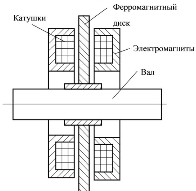
2. Электромеханическая система магнитоэстрикционного преобразователя. Составьте эквивалентную схему ЭМС в Matlab Simulink.
