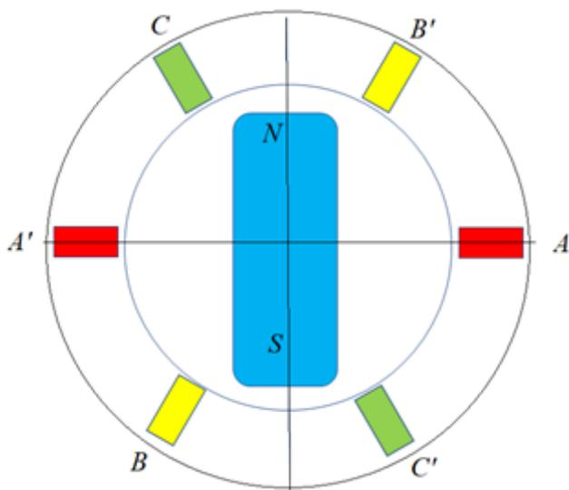
7. Электромеханическая система состоит из постоянного магнита, вращающегося в системе трехфазных катушек с постоянной скоростью. Изобразите графики изменений ЭДС фазных обмоток при вращении постоянного магнита. Начальный угол показан на рисунке.
