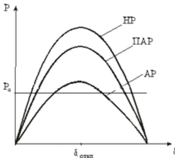
3. Устойчива ли динамически система при заданном значении угла отключения. Построить площадки ускорения и торможения
