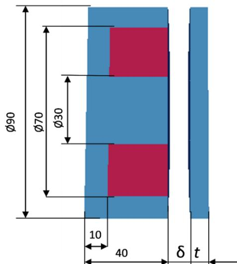
10. Определите сопротивление электромагнита переменного тока со сплошным стальным сердечником
