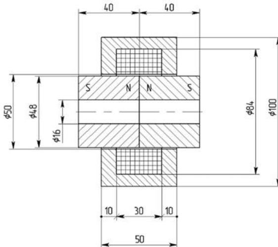
11. Рассчитать и построить распределение векторов намагниченности при перемещении внутренней части магнитной системы в пределах  $X = \pm 16$  мм.
