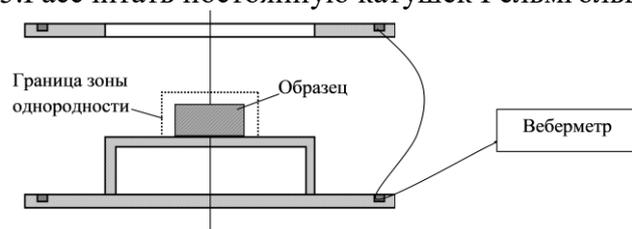
6. Рассчитать магнитный момент цилиндрического ПМ (диаметр 20 мм, высота 10 мм, намагничен по оси  $M=1200$  кА/м) в катушках Гельмгольца.
