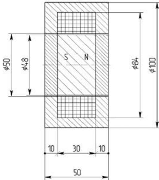
10. Рассчитать и построить распределение векторов намагниченности при перемещении внутренней части магнитной системы в пределах  $X = \pm 16$  мм.
