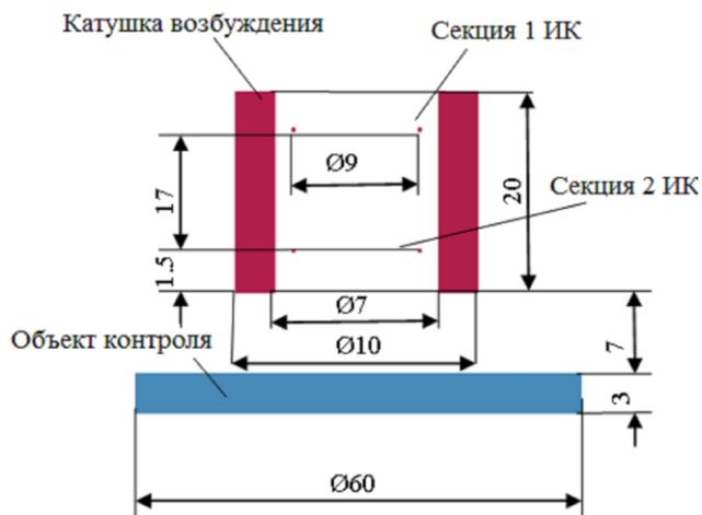
2. Рассчитать параметры проходного датчика для электромагнитного контроля диаметра стержня.
