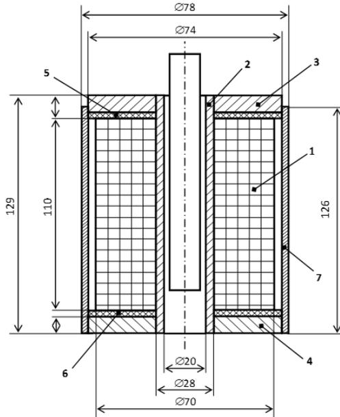
8. Рассчитать статическую тяговую характеристику электромагнитного подвеса  $P_{\text{Э}}(\delta)$  для тока в катушке соленоида 0,4 А и якоря в виде полого цилиндрического стержня с внешним диаметром 17 мм, внутренним диаметром 10 мм и длиной 110 мм с кожухом.
