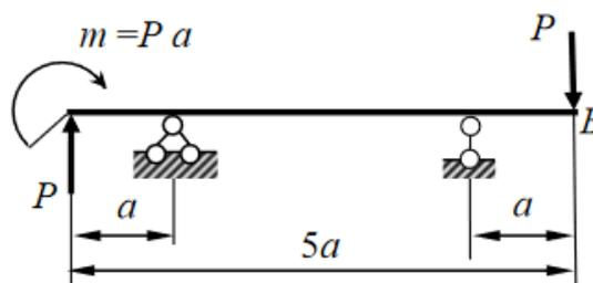
2. Определить угол поворота сечения В.
