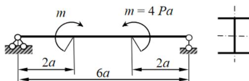
Из расчета на жесткость подобрать номер прокатного профиля балки, если  $a = 2$  м,  $P = 25$  кН,  $E = 2 \cdot 10^{11}$  Па,
