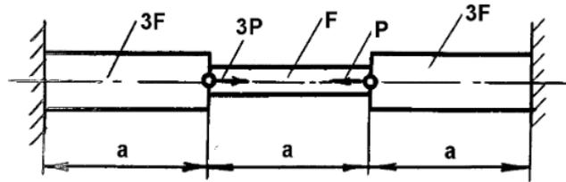
Построить эпюру напряжений и перемещений сечений, определить  $\sigma_{\max}$ .
