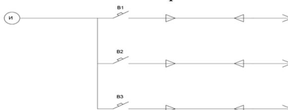
3.На рисунке показана защита кабелей проложенных в коллекторе. Сработал выключатель В2. Как найти и
