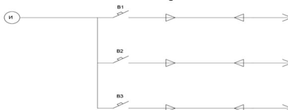
3. На рисунке показана защита кабелей проложенных в коллекторе. Сработал выключатель В2. Как найти и устранить причину, по которой он сработал? Какие правила и нормы следует соблюдать, чтобы обеспечить безопасность работников?
