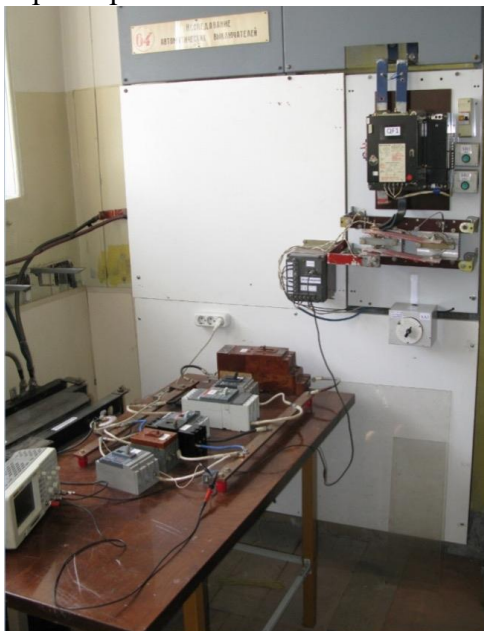
Figure 1 Рисунок 1. Общий вид стенда по исследованию автоматических выключателей
