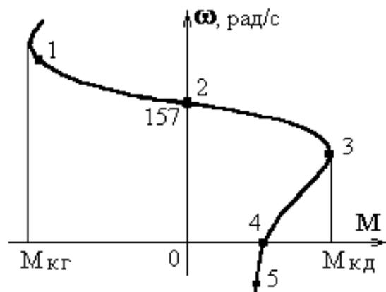
9. Определите напряжение  $U_1$ , приложенное к статору асинхронного двигателя для получения искусственной характеристики, показанной на рис. Сопротивлением статора можно пренебречь  $R_1 \gg 0$ ; номинальная частота сети  $f_1=50 \text{ Гц}$ ; номинальное напряжение  $U_{1N}=220 \text{ В}$ ; частота на искусственной характеристике  $f_I=25 \text{ Гц}$ ; число пар полюсов  $p=2$ .
