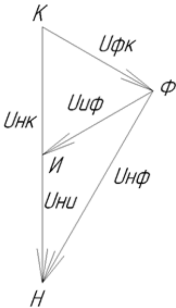
Figure 7 Рисунок 2- Векторная диаграмма напряжений во вторичных обмотках разомкнутого треугольника ТН
