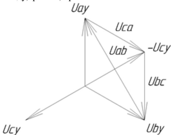
Figure 8 Рисунок 2- Векторная диаграмма напряжений во вторичных обмотках звезды ТН
