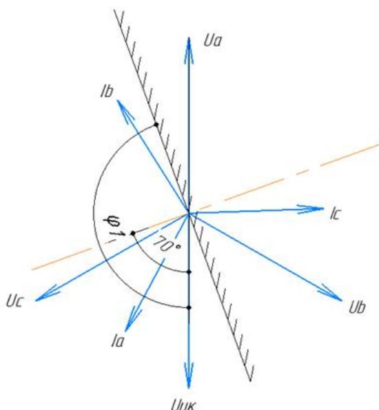
Figure 20 Рисунок 3 - Характеристика срабатывания РНМ
