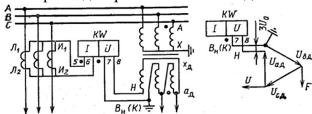
Figure 15 Рисунок 1 - Схема включения реле направления мощности нулевой последовательности
