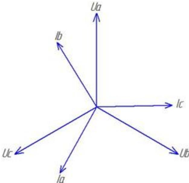
Figure 19 Рисунок 2 - Векторная диаграмма токов и напряжений
