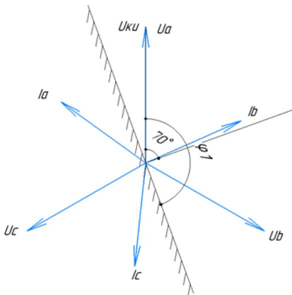
Figure 17 Рисунок 3 - Характеристика срабатывания РНМ
