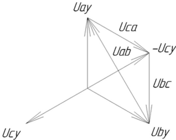
Figure 10 Рисунок 2- Векторная диаграмма напряжений во вторичных обмотках звезды ТН
